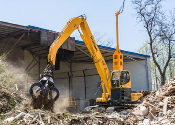
장비에 장착된 전기모터의 강력한 출력으로 버켓, 폐기를 핸들링, 오퍼 등 다양한 작업 수행이 가능한 유선형 전기굴착기 (Electric Excavator)
