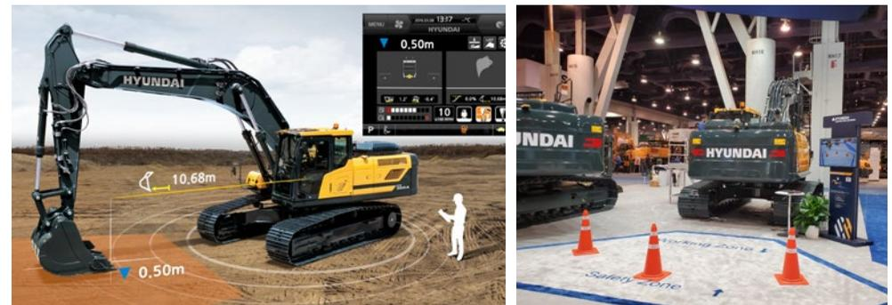
Hi ASSIST 활용, 실시간 측량 및 자동 제어 | Hi DETECT 활용, 작업 현장 위험요소 감지 및 안전사고 예방
